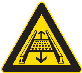
W029 Warnung vor Gefahren durch eine Förderanlage im Gleis
